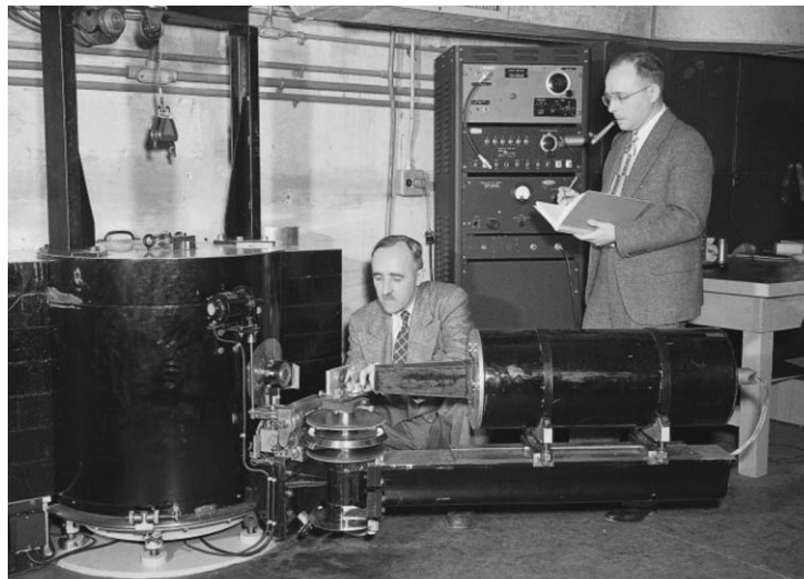
Clifford Shull (derecha) y Ernest O. Wollan con un espectrómetro de neutrones de doble cristal, en el reactor ORNL X-10 de grafito, en 1949.
